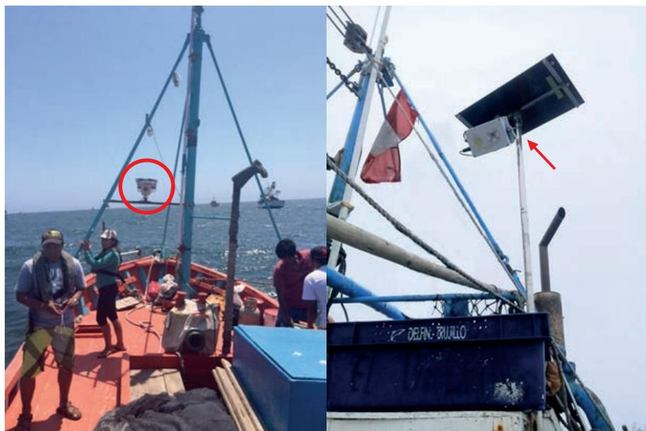
*Figura 65. Localización de las cámaras de toma automática, sobre una estructura metálica (izquierda) y sobre la caceta de embarcación (derecha).*
